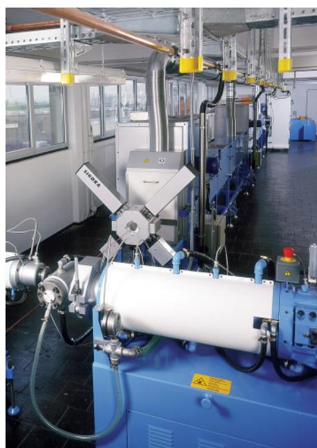
Bild links: Silicon-Extruder
