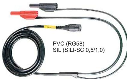
Hoch flexible, durchgehend abgeschirmte Adapterleitungen. Eine Seite berührungsge- schützter BNC-Stecker, andere Seite stapelba-re Ø 4 mm-Lamellenstecker mit starrer Isolierhülse.
