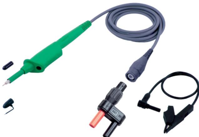
Demodulator-Tastkopfset zur Messung hochfrequenter Signale mittels handelsüblicher Multimeter. Der mitgelieferte Adapter XF-SS/4 gestattet den Anschluss des Tastkopfes auch an Messgeräte mit Ø 4 mm-Sicherheitsbuchsen.
