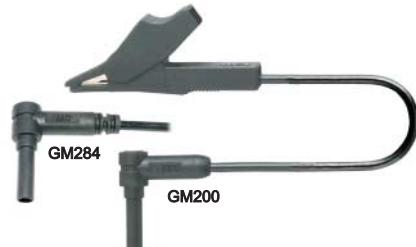
Hoch flexible Referenzleitungen mit PVC- oder Silicon-Isolierung. Eine Seite 90° abgewinkelte Ø 2 mm-Stecker mit starrer Isolierhülse, andere Seite Krokodilklemme mit allseitiger Isolierung und gezahntem Maul mit Feindrahtfläche.
