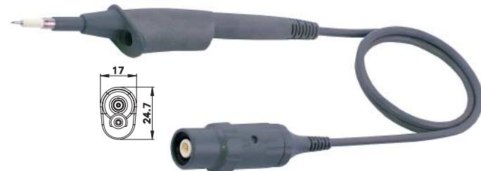
Sicherheits-Hochfrequenz-Tastkopf 10:1. Hoch flexible, PVC-isolierte koaxiale Anschlussleitung mit BNC-Stecker mit integrierter Kompensationseinheit. Ø 2 mm-Sicherheitsbuchse für Referenzanschluss im Griffteil des Tastkopfes. Mit langer Anschlussleitung, speziell geeignet, um grössere Distanzen zwischen Messgerät und Messobjekt zu überbrücken.
