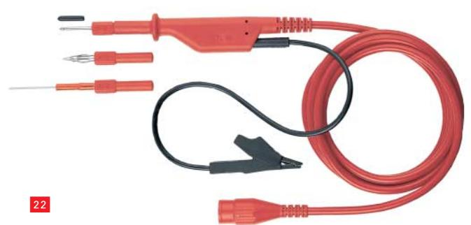
Sicherheits-Prüfspitzenset, bestehend aus Griffteil mit Silicon-isolierter, koaxialer Anschlussleitung mit BNC-Stecker und aufsteckbaren Adaptoren für unterschiedliche Messabgriffe. Der Ø 4 mm-Sicherheitsstecker an der Frontseite des Griffteils ist steck-kompatibel zu allen Abgreifern und Prüfspitzen mit starren Ø 4 mm-Buchsen. Ø 2 mm-Sicherheitsbuchse für Referenzanschluss im Griffteil.
