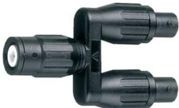
BNC-Sicherheits-Signalverteiler (Abzweig). Es sind alle Innenleiter und alle Abschirmungen miteinander verbunden. Kontaktstifte und -buchsen des Innenleiters der BNC-Steckverbinder aus vergoldetem Messing.
