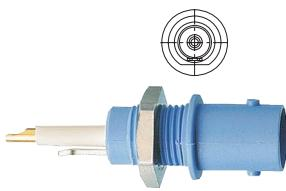
Berührungsgeschützte BNC-Einbaubuchsen zur Aufnahme von BNC-Steckern. Die Buchsen werden in Bohrungen von Platten oder Gehäusen aus Kunststoff, Metall etc. eingebaut. Abschirmung vernickelt, Kontaktbuchse des Innenleiters aus vergoldetem Messing. Typ XBB-LL mit verlängerter Abschirmung für bessere Einstrahlungsunterdrückung im ungesteckten Zustand. Lötanschluss.
