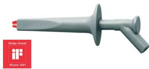
Abgreifklemme mit Klauenpaar aus Stahl zum Abgreifen von Stromleitern. Zur erhöhten Sicherheit bei der Kontaktierung ist das Klauenpaar aussen isoliert. Starre Ø 4 mm-Buchse im Drückerteil, geeignet zur Aufnahme federnder Ø 4 mm-Stecker mit starrer Isolierhülse.
