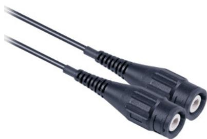
Berührungsgeschützte, PVC-isolierte koaxiale Messleitungen. Ausführung beidseitig mit BNC-Stecker. Abschirmung der BNC-Steckverbinder vernickelt, Kontaktstifte und -buchsen des Innenleiters aus vergoldetem Messing.
