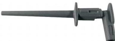
Abgreifer mit gehärteter, im Kontaktbereich vergoldeter Federdrahtklammer. Starrer □ 0,63 mm-Stift zum Kontaktieren mit gefederten □ 0,63 mm- oder Ø 0,78 mm-Buchsen.
