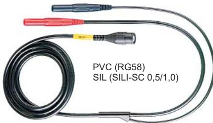
Hoch flexible, durchgehend abgeschirmte Adapterleitungen. Eine Seite berührungs geschützter BNC-Stecker, andere Seite axiale Ø 4 mm-Lamellenstecker mit starrer Isolierhülse.
