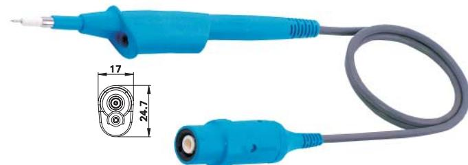
Sicherheits-Hochfrequenz-Tastkopf 100:1 für die sichere Erfassung hoher Spannungen. Hoch flexible, PVC-isolierte koaxiale Anschlussleitung mit BNC-Stecker mit integrierter Kompen-sationseinheit. Ø 2 mm-Sicherheitsbuchse für Referenzanschluss im Griffteil des Tastkopfes. Durch geringe Eingangskapazität und grossen Eingangswiderstand ist dieser Tastkopf auch beson-ders geeignet für Messungen an empfindli-chen Schaltkreisen.
