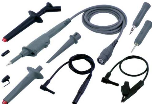
Tastkopfset mit besonders reichhaltigem Zubehör, geeignet beispielsweise für Starkstromtechniker, die Messungen direkt am Netz ausführen. Die Silicon-isolierte Anschlussleitung des „Deluxe“-Tastkopfes ist in einem weiten Temperaturbereich höchst flexibel und sogar beständig gegen kurzzeitige Berührung mit dem heißen Lötkolben.
