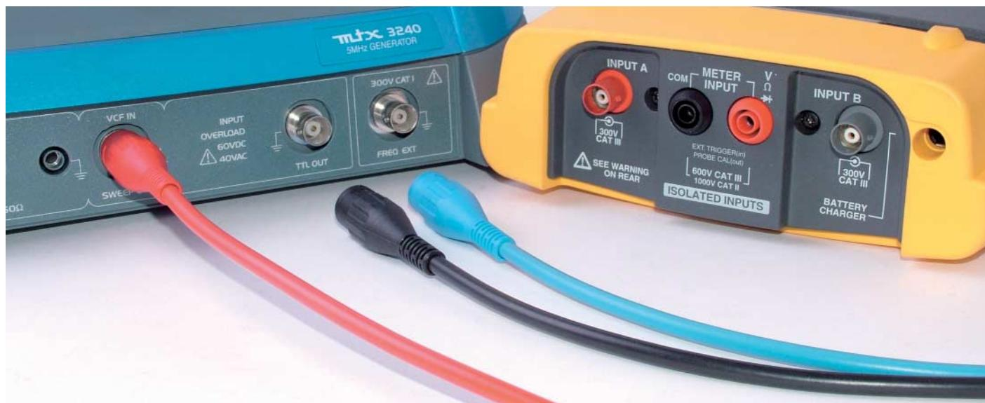
Messleitungen mit berührungs geschützten BNC-Steckern lassen sich an Geräte mit isolierten und herkömmlichen BNC-Buchsen anschliessen.
