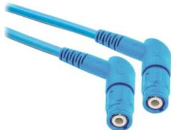
Berührungs geschützte, PVC- oder Silicon-isierte koaxiale Messleitungen, beidseitig mit BNC-Steckern, abgewinkelt für ergonomisch günstige Kabelführung und 360° drehbar um die Steckachse. Abschirmung der BNC-Stekkerverbinde vernickelt, Kontaktstifte des Innenleiters aus vergoldetem Messing.
